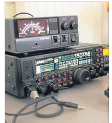
Die Welt auf dem Schreibtisch: Ein Kurzwellen-Sende-Empfangsgerät mit Netzteil und ein UKW-Sende-Empfangsgerät gehören zu Greves Ausrüstung.
